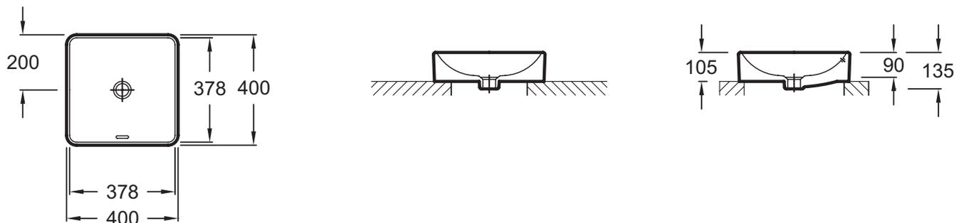
Descriptif CCTP : Vasque à poser 40 x 40 cm, avec trop-plein. EVG102. Collection : VOX. DIMENSIONS : 40 x 40 cm. POIDS : 10,6 kg. MATÉRIAU : Céramique. TYPE D'INSTALLATION : Posé. PERCEMENT ROBINETTERIE : Sans trou de robinetterie. CONFIGURATION : STANDARD. MEULÉ/NON-MEULÉ : Meulé, pour une installation parfaite avec un meuble ou un plan de travail. TROP-PLEIN : Avec trou de trop plein. ROBINETTERIE CONSEILLÉE : Composed.
